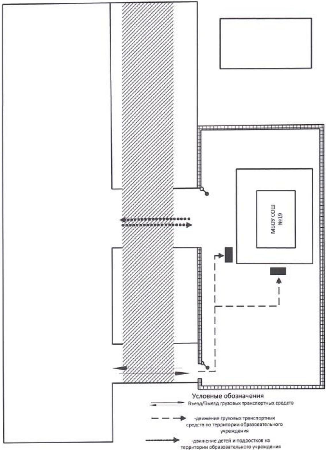
**План-схема движения транспортных средств и обучающихся при проведении дорожных, ремонтно-строительных работ вблизи МБОУ СОШ № 19**
